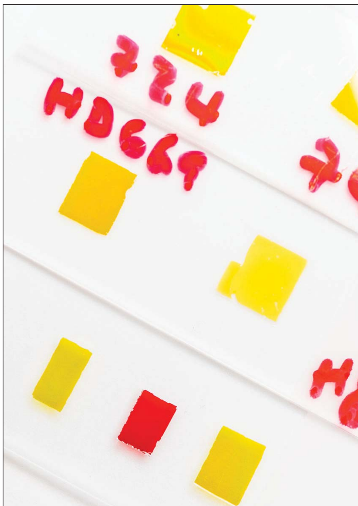
图1: 使用HVPE生长的铝III-V太阳能电池样品,显示为在去除与玻璃手柄衬底键合的GaAs衬底以进行透射测量的 Al_x(Ga_{1-x})_{0.5}In_{0.5}P 薄膜。颜色的差异是由于Al和Ga的成分不同所引起的。具体而言,黄色样品为AlInP(无Ga),橙色样品为AlGaInP。NREL的Dennis Schroeder拍摄。
