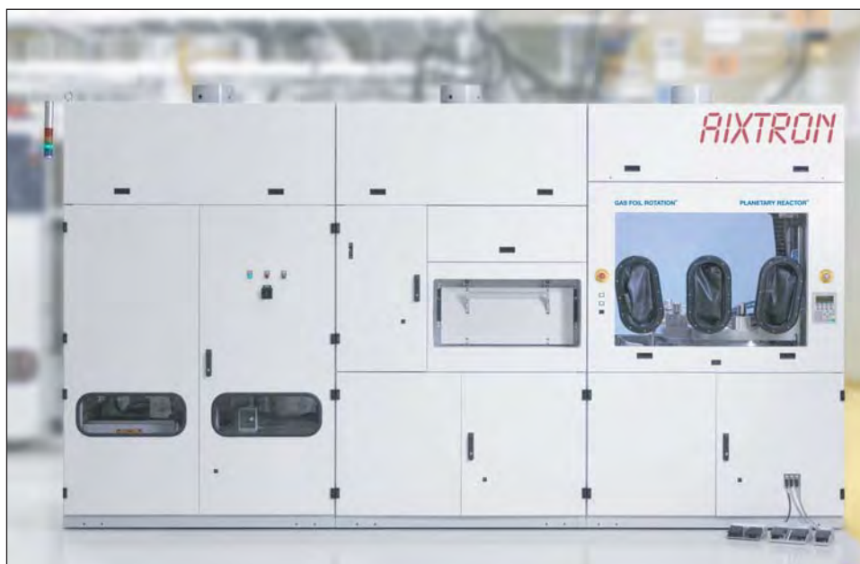
图1. Aixtron的AIX G5的行星型反应器。
